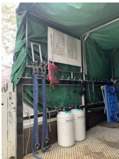
写真 2：トラックの荷台に設置したアルミフレームと有孔ボード、および A3 サイズのバーコードマップ
