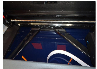
図 1 漏れたレジンが溜まった本体 (Form3L) 内部
