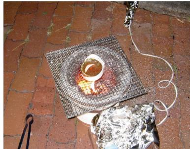
図 3b 坩堝破損
