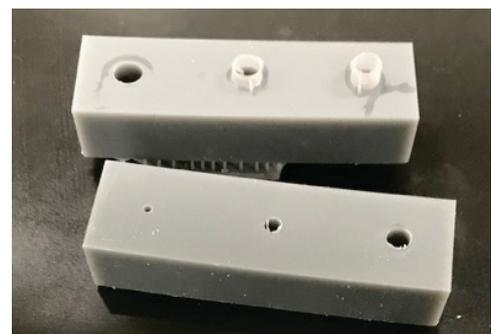
設計初心者で、ネジ穴を上手く設計できなかったため、ネジ穴ウィザードを使って設計したが、失敗した
