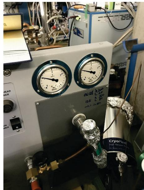
写真 3 交換した圧力計、ヘリウム充填中
