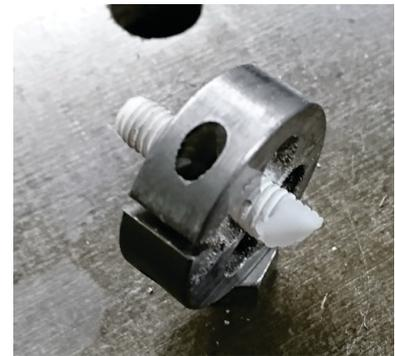
ダイスで加工している途中で折れてしまった M6 ネジ
