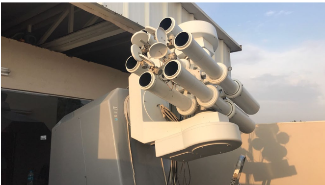
イカ大学設置のフレア監視望遠鏡
