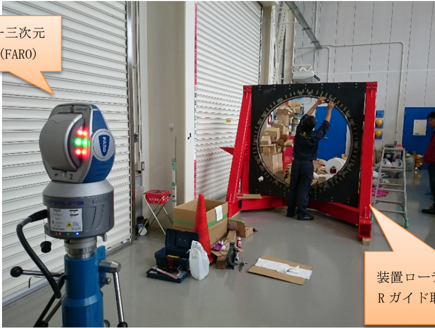
三次元測定機を用いた装置ローテータ固定部の測定・調整
