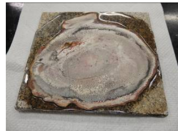
試料切断後、ある程度試料を研磨した状態 (④)。
