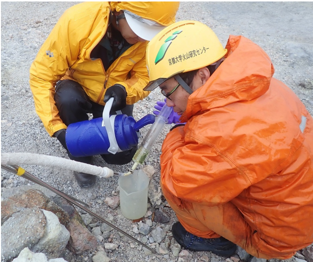
シリンジを氷水で冷やし凝縮促進させガス採取
