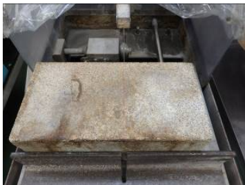
大型切断機による石材の切断 (①)。
