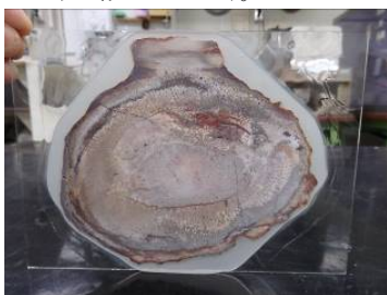
さらに研磨を進めた試料 (⑩)。石材はなくなったが、まだ試料は厚い。
