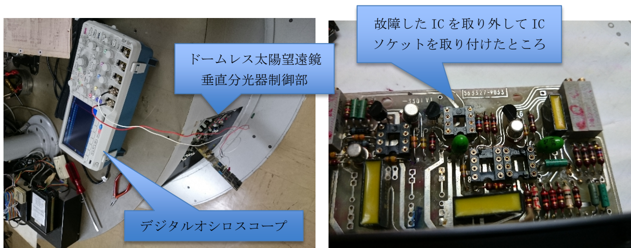
デジタルオシロスコープを用いた不具合箇所の特定制および故障プリントボードの修理
