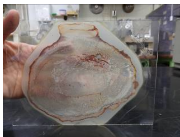
研磨が終了した試料 (⑩)。試料は薄くなり、背後の指が透けてみえる。
