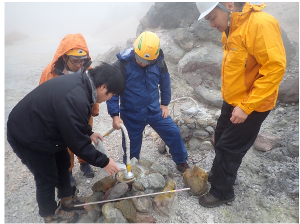
噴気チムニーへガスサンプリング機材の設置
