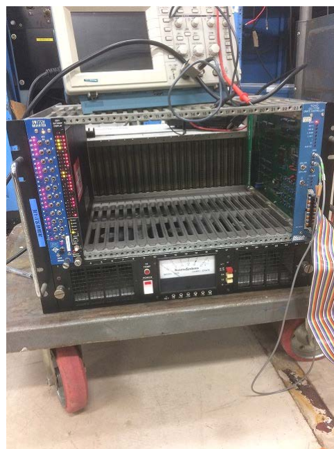
図3. 修理後テスト中のCAMACクレートコントローラー(右端の青いモジュール)
