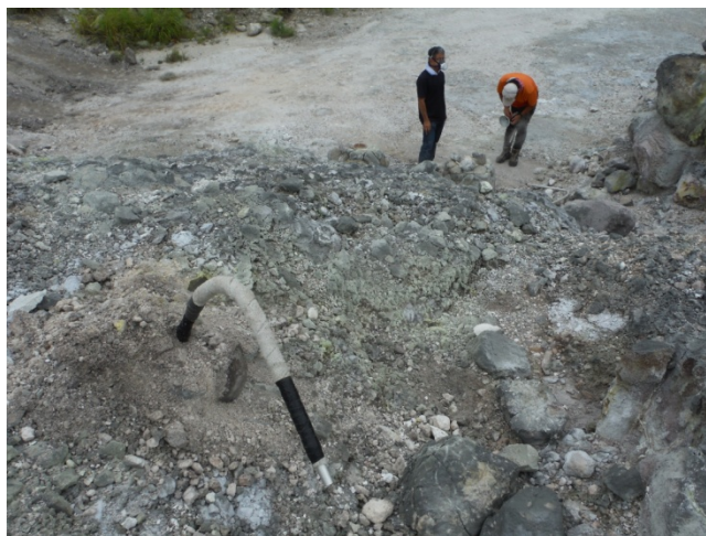
図4：サンプリング用アルミ管設置作業
