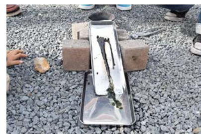
溶融物をバットに流し込んだところ。冷却速度が速いため、冷え固まった溶融物はガラスとなる。
