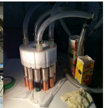
図3. 冷却水漏れテスト
