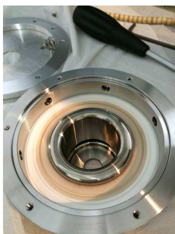
図 5. レンズ絶縁セラミック交換
