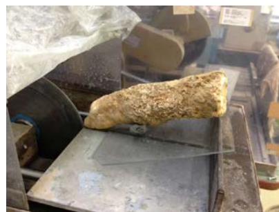
図6 技術補助の例（鍾乳石の切断）。鍾乳石が大きく切断機のテーブルスライドに収まらなかったため、厚みのあるアクリル板に載せて傾斜をつけ切断した。
