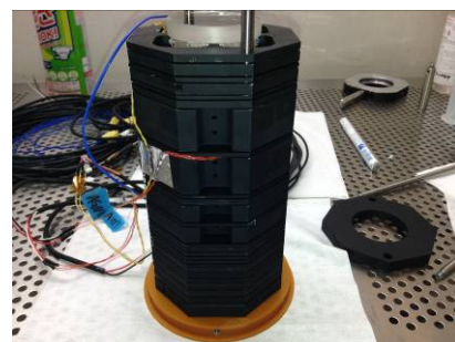
新チューナブルフィルターの内部構造。各種素子をホルダーに接着しオイル張りし積層する。
