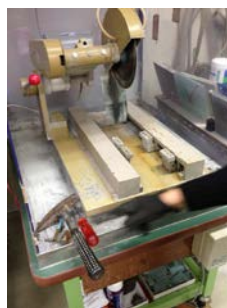
図4 自動切断機の解体の様子。一部引き取り修理につき解体している。
