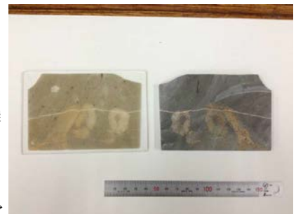
← 図2 失敗した依頼（石英のマウント）。流体が結晶の中に閉じ込められているもので、2つの包有物を傷つけずに一方の包有物近傍（約5 μm）まで削り出す必要があったが、研磨途中で結晶に深い傷が入り流体が流出してしまった。
