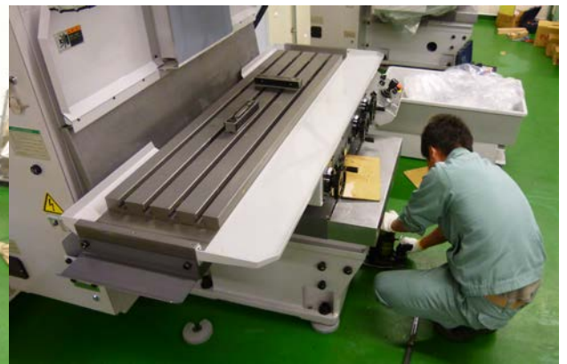
工作機械のレベル出し。機械精度を発揮するにはこのレベル調整が重要。水準器を前後左右の二箇所において、傾きだけでなくねじれも無いようにする。
