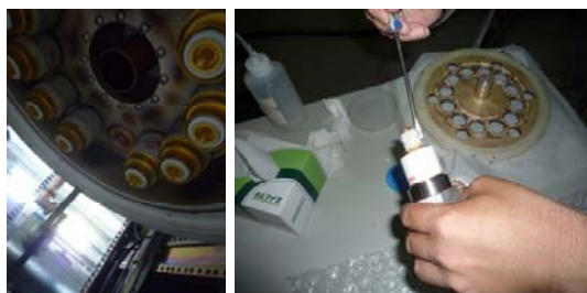
真空管取り外し
