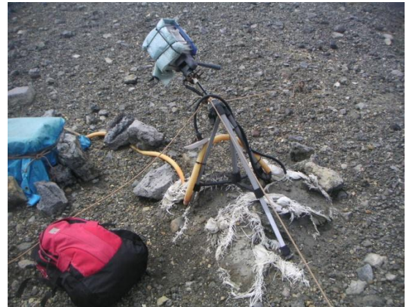
図 1. 火山ガスによって腐食したカメラ機材
