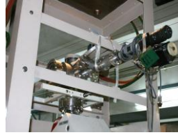
偏向電磁石の上に取り付けたFCと蛍光板はリモート制御を行う
